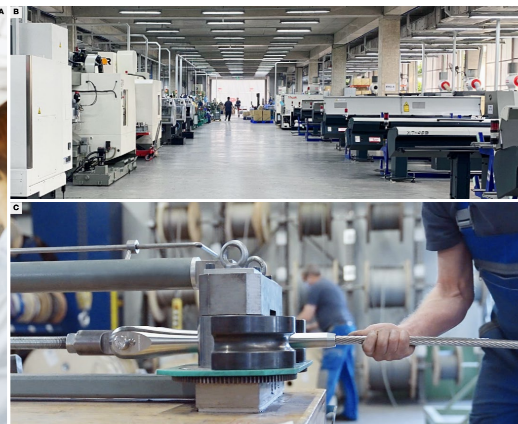
A Planung und Engineering · Planification et ingénierie · Design and engineering B Jakob eigene CNC-Fertigung in Saigon · Unité Jakob de fabrication CNO en interne à Saigon · Jakob in-house CNC manufacture in Saigon C Walzen von Aussengewinden · Usinage de filetages externes · Rolling of external threads D Kontrolliertes Ablängen und Vorrecken · Découpe et pré-étirements contrôlés · Controlled cutting to length and pre-stressing E Montage · Montage · Assembly
